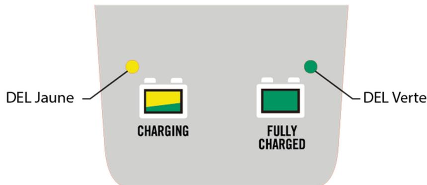
Quand le courant alternatif est appliqué au chargeur la première fois, toutes les DEL s'allument pendant deux ou trois secondes avant de démarrer la séquence de charge énumérée ci-dessous.
